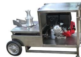
WINCHE PORTÁTIL 2000 KG C/ MOTOR GX 270 TORO 2.0 Código: 936520
